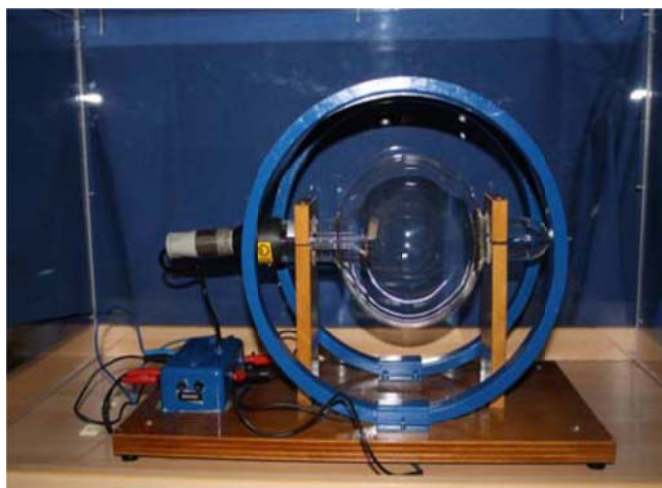
Figura 5. Dispositivo montado sobre un carro para la visualización de la trayectoria de los electrones en el seno de un campo magnético (con Webcam incorporada).
